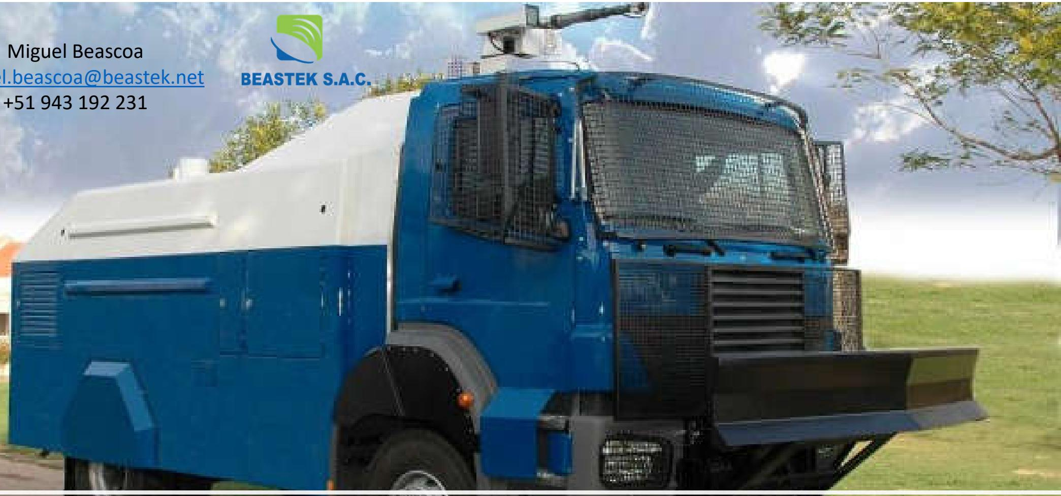
Camión antidisturbios modelo RCU 6000 sobre chasis 4x4 Mercedes Benz
